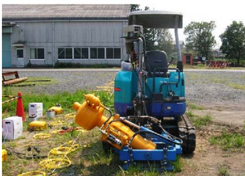
DAQ Link による P/S 波浅層反射地盤調査例。 震源はジオシス保有の小型油圧インパクト
