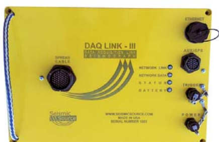
DAQ LinkIII A/D ユニット(アルミケース。裏面に取り外し可能なモデムユニットあり)
