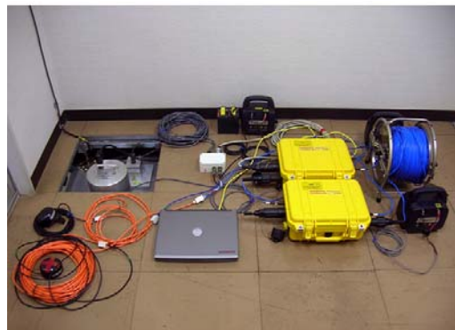
DAQ による MEMS 加速度計連続地震観測テスト
