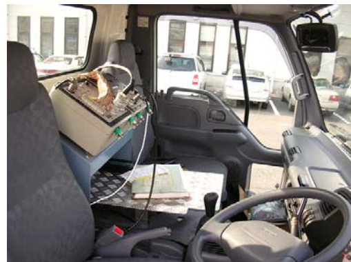
トラックキャビン内に搭載された制御装置
