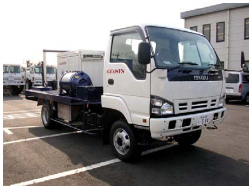
‘minivib’ T-15000 全景 (4tトラック搭載)
