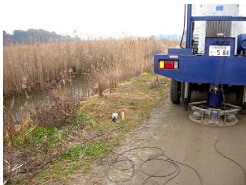
マス及びベースプレートはリフトシリンダーを介し、トラック車重が荷重となり有効的に地面に押し付けられる
