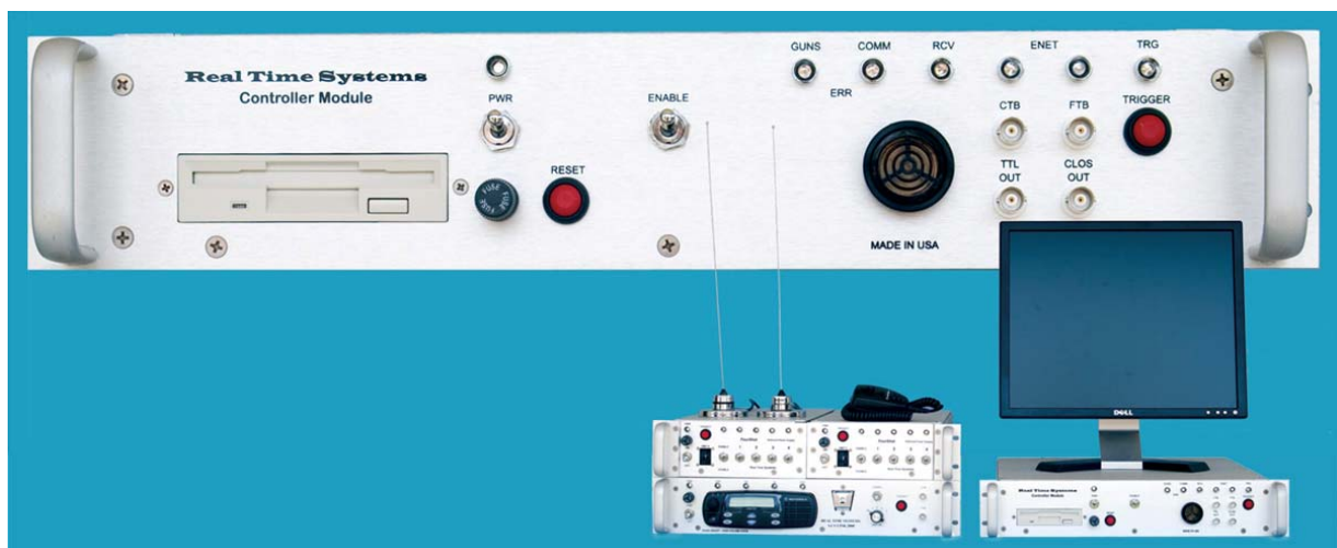
Long Shot コントローラ(上)、コントローラ+4ch パワーサプライ×2+ラジオリンク(下)+モニター
