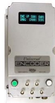
Universal Encoder を使用することで、 無線による遠隔操作が可能
