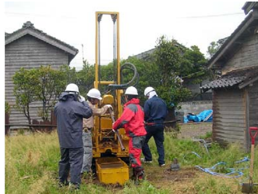
能登地震後、門前町における液状化地域の砂礫層サンプリング
